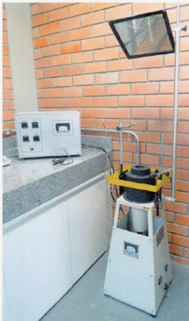
Figura 1 - Equipamento: forno ISO 1182
